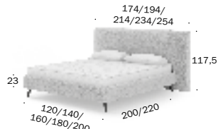
Tiefe Kopfteil/Depth headboard 17cm Überstand Kopfteil je Seite/ Headboard overhang per side 20cm Tiefe Bettrahmen/Depth bed frames 4,5cm Bodenfreiheit/Ground clearance 15cm
