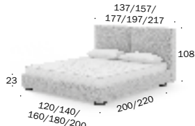
Tiefe Kopfteil/Depth headboard 20cm Überstand Kopfteil je Seite/ Headboard overhang per side 4,5 cm Tiefe Bettrahmen/Depth bed frames 2,5cm Bodenfreiheit/Ground clearance 5cm
