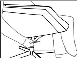
linken Hebel nach oben ziehen → Entriegeln des Rückenteils
